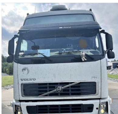
Sikthindring frontrute. Foto: Statens vegvesen
